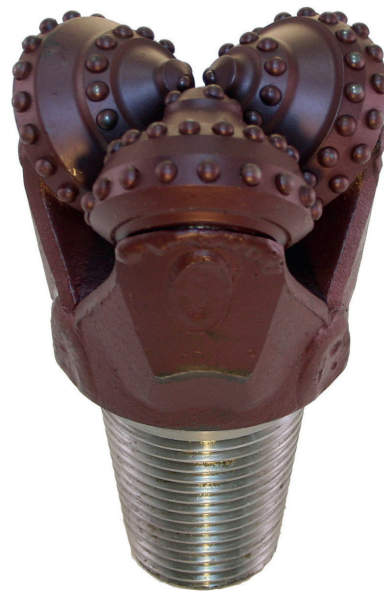
Шарошечное долото с твёрдосплавным зубом.
